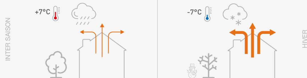
En se basant sur ce constat simple, Mitsubishi Electric a conçu ses pompes à chaleur PUD au R32 pour optimiser leur consommation énergétique. Grâce à la technologie Inverter, le compresseur est déjà optimisé pour tourner moins vite en intersaison (travail en charge partielle). Ceci permet d'obtenir une meilleure efficacité énergétique (COP plus élevé), sans toutefois nuire au confort de l'utilisateur.
